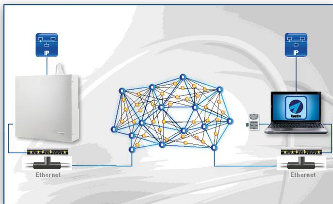
Il Software di telegestione TCP/IP consente di gestire da remoto i Sistemi Tecnoalarm tramite un pc in rete ethernet o WAN. Il software TCP/IP (ambiente Windows), gestisce le comunicazioni tra i Sistemi Tecnoalarm ed il pc. È possibile gestire da remoto la ricezione delle notifiche eventi, programmare e gestire i Sistemi con vettori di comunicazione IP o GPRS. Con l'interfaccia PROG USB è possibile programmare i Sistemi anche in modalità locale. Il Software può telegestire fino a 1000 utenze.
